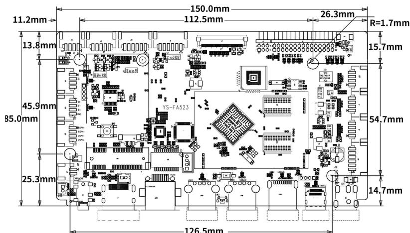
\*PCBA 长度: 150mm \*PCBA 宽度: 85mm \*PCBA 高度: 12mm \*PCBA 螺丝直孔径: 3.4mm x4
